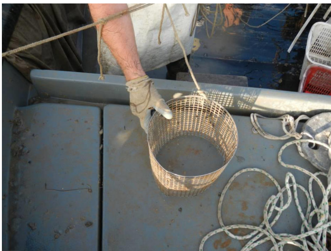
Foto 14.2: Cestello captatore inserito all'interno della "finta tira".
