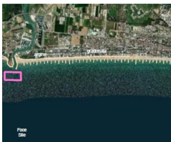
Figura 8.4: Celle di dragaggio di foce fiume Sile, in rosa sono evidenziate le celle utilizzate per gli interventi 2020
