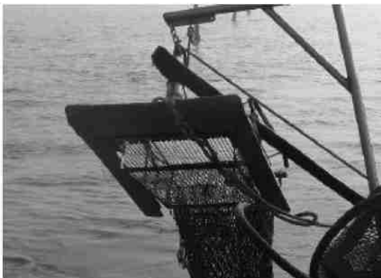
Figura 26. Draga idraulica o turbosoffiante (fonte: Consorzio Cooperative Pescatori del Polesine O.P., 2007).
