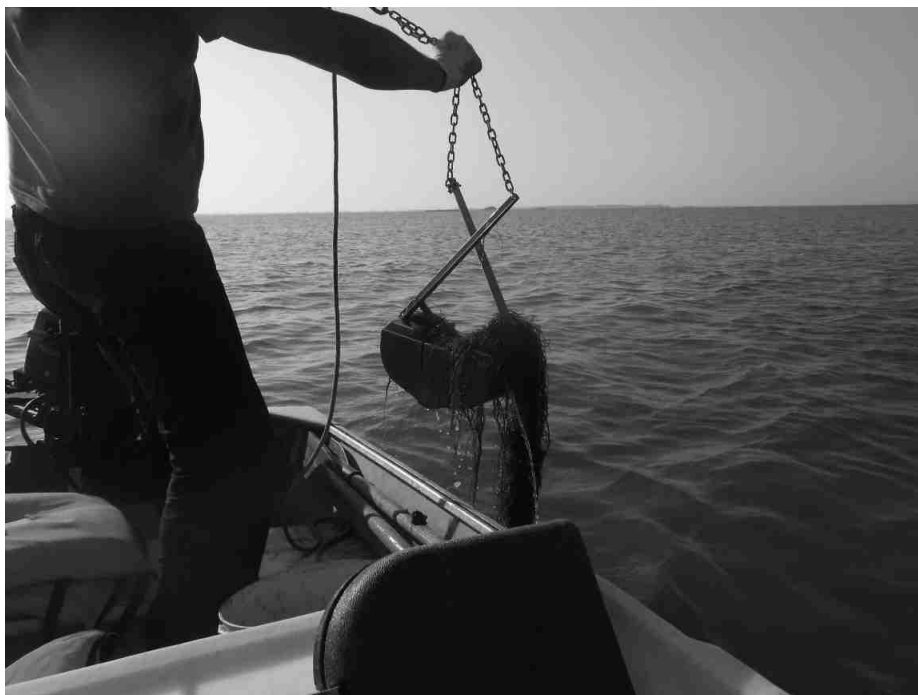
Figura 42. Prelievo con benna van Veen per valutazione del benthos e della risorsa Tapes.
