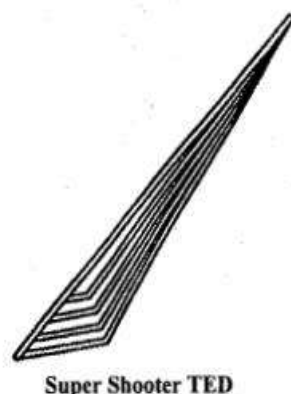
Figura 1.15: Sezione del TED Supershooter (GSM Fisheries Commission, 1995)
