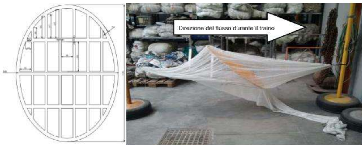
Figura 1.16: Schema del TED FlexGrid (Fonte: Tartalife, 2017).
