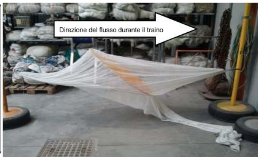
Figura 7.2.1.3: Schema del TED FlexGrid (Fonte: Tartalife, 2017).
