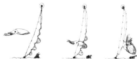
Fig.11 - Schema di tramaglio
